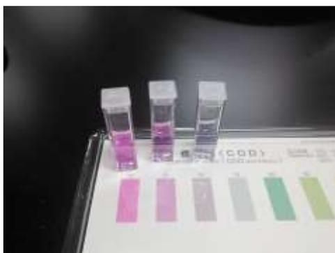
図1 作成したサンプル 左から0ppm、5ppm、10ppm
