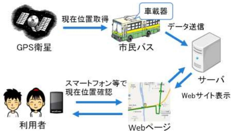
図 1 システムの概要図
