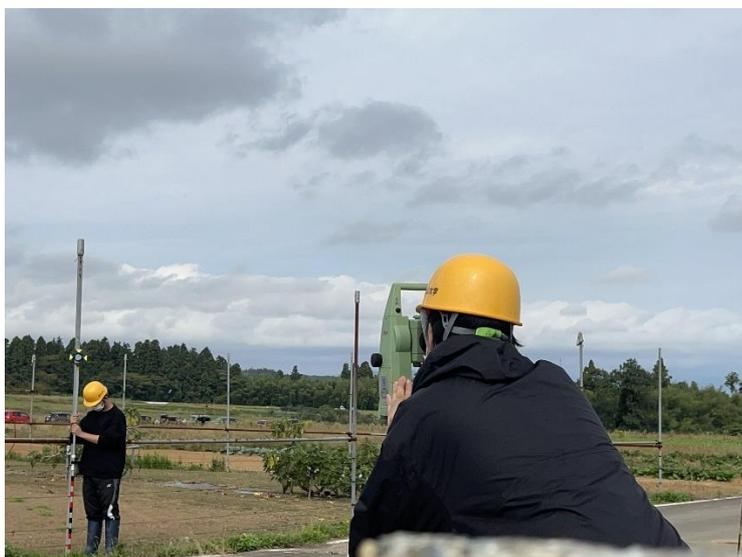
呉羽山断層の上下変位量の測量
