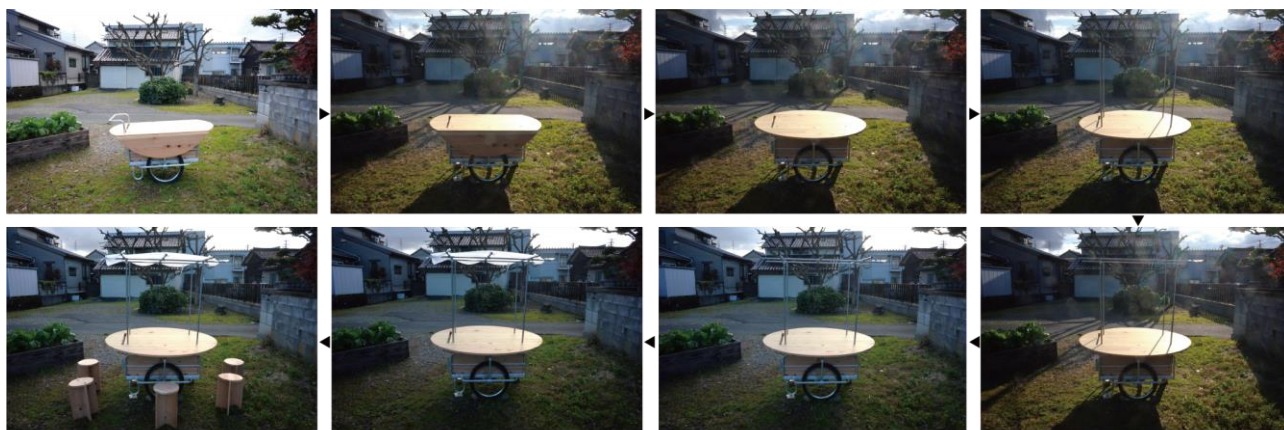
写真6 モバイル屋台「えん」の組立手順
